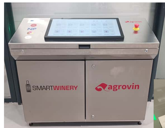
Εικόνα 4. Σύστημα ελέγχου δεξαμενών
